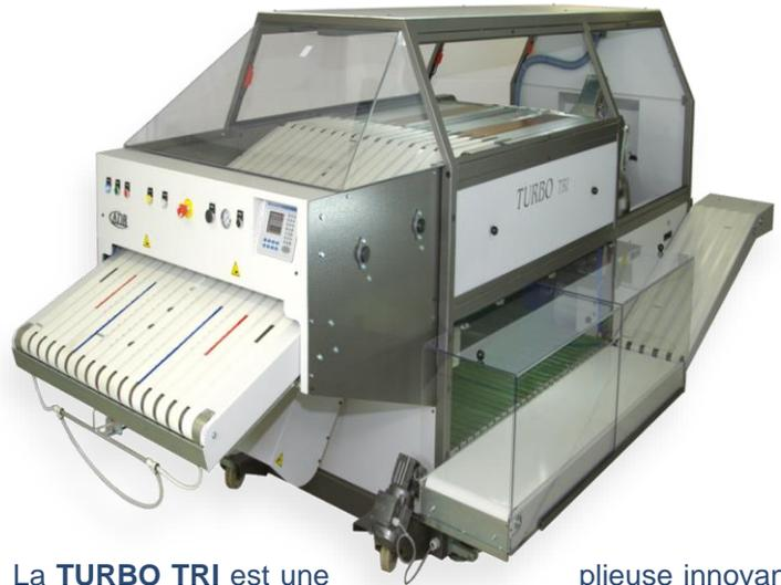
La **TURBO TRI** est une plieuse innovante et polyvalente, conçue pour plier, trier et empiler des articles textiles très diversifiés en formes, dimensions ou épaisseurs. Tels que : Peignoirs, draps de bain, draps housse, éponges, taies, tee-shirts, pantalons, blouses, couvertures...
