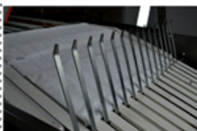
2 e pli transversal arrière par volet à doigts
