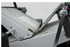
3 e et 4 e pli longitudinal par volets pleins, à compensation d'épaisseur, pour une très grande qualité de pliage
