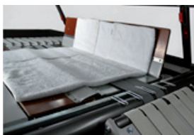
3 e et 4 e pli longitudinal par volets pleins, à compensation d'épaisseur, pour une très grande qualité de pliage
